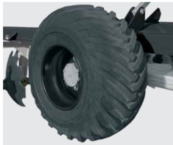
Rodeiro para transporte com pneus 400 x 60. Wheelset for transport with tires 400 x 60. Rodado para transporte com pneumáticos 400 x 60.
