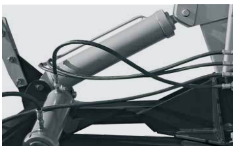
Cilindros hidráulicos de articulação para transporte e para levantamento dos pneus. Articulation hydraulic pistons for transport and tires lifting. Cilindros hidráulicos de articulación para transporte y levantamiento de los neumáticos.
